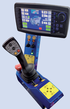
CONSOLE DI COMANDO ELETTRONICO CON JOYSTICK ERGONOMICO E MONITOR DEDICATO PER IL CONTROLLO DELLE FUNZIONI DIRETTAMENTE DAL POSTO GUIDA
